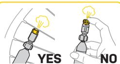
エア充填後、CO<sub>2</sub>インフレーターヘッドをスポークに数回押し当てて、内部のガスが完全に使い切られていることを確認してください。
