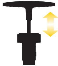
ポンピングしてエアーチamberに空気を充填します。
