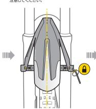
6. 前フェンダー レッグを、図のように後フェンダー レッグの上に取り付ます。 タイヤとフェンダー間のクリアランスが35mmになるように取付位置を調節し、 両側のボルトを締めます。
