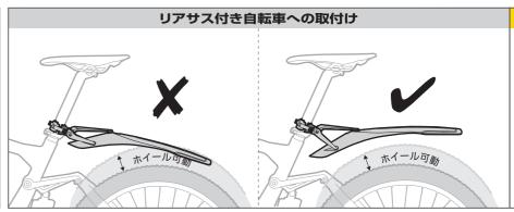
ディフェンダー XC11の 取付け角度を調整する際には ディフェンダーXC11とタイヤ の間隔をホイール可動量より 多くなるようにしてください。 不正確な角度と間隔は ディフェンダーXC11や 自転車を破損させたり、ケガを 負ったりする恐れがあります。
