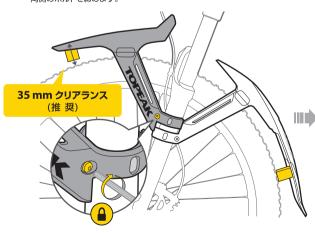
6. 図のように、フェンダー(前)とフェンダー(後)の両方に付属のステッカーを貼り、 フォームスペーサーを取外します。
