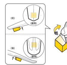
4. 後フェンダー レッグをフォーク レッグに取り付けます。 タイヤとフェンダー間のクリアランスが35mmになるように 取付位置を調節します。
