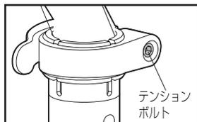
しっかりと固定するために5mmの六角レンチでテンションボルトを締付けて調整してください。
