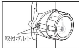
調節ノブを締め過ぎたときは、5mmの六角レンチで取付ボルトをゆるめます。
