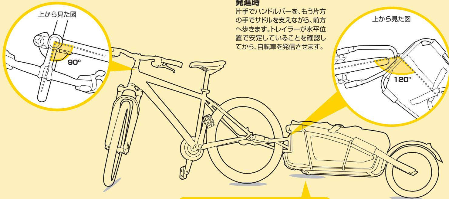
図のように、駐輪時はトレーラー下部が接地します。
