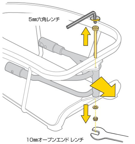
M6ボルトを抜き取り、トレーラー ヨークを取り外してください。
