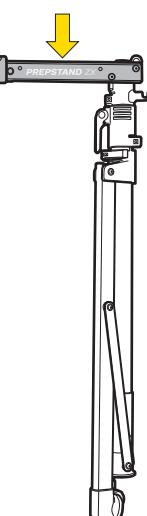
下部クイックリースクランプレバーを開き、脚部の固定を解除します。
