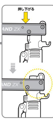
脚部を完全に開き、下部クイックリースクランプレバーを締めます。
