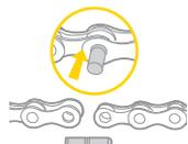
新しいチェーンピンの挿入、または古いチェーンピンの抜き取り。
