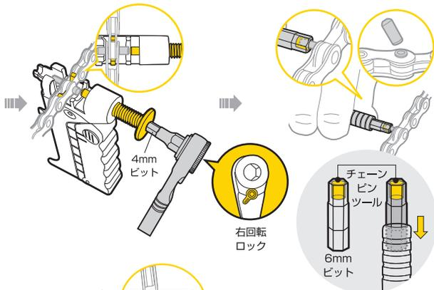
リンクの動きが硬い場合には、図のようにチェーンピンを僅か押しつけて緩めます。
