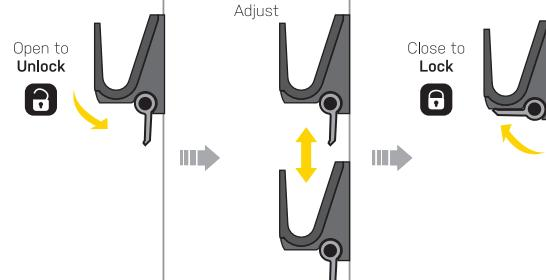
Schnellspannhebel öffnen, um die Haken zu verschieben. Schnellspannhebel schließen, um die Haken in der eingestellten Position zu arretieren.
