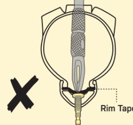
Plug-Einstecher niemals zu tief in den Reifen einstechen, da dieser andernfalls das Felgenband beschädigen und somit zu einer Undichtigkeit führen könnte
