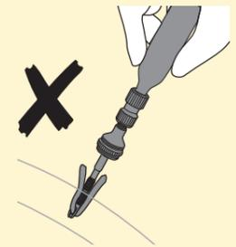
Reifenreparatur nicht beginnen, wenn am CO2-Inflator eine gefüllte CO2-Kartusche montiert ist, um ein versehentliches Ausströmen des Gases zu verhindern.
