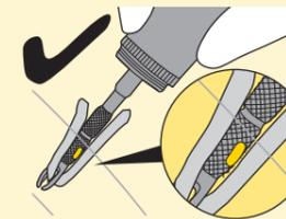
Den Plug-Einstecher während der Reparatur nicht verdrehen, um die CO2-Öffnung frei zu halten. Wenn die Öffnung durch den Plug blockiert ist, kann während des Befüllens fälschlicherweise CO2 aus dem Werkzeug austreten
